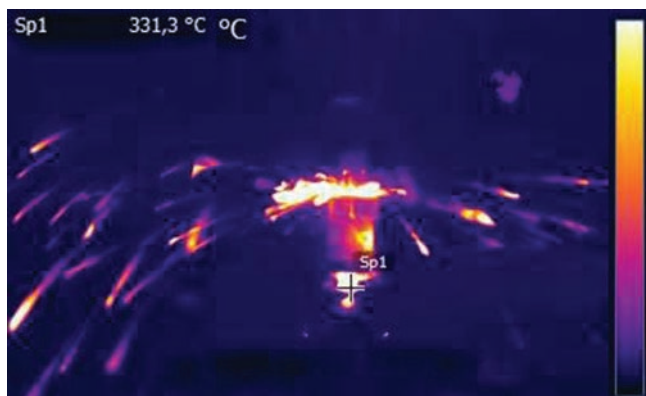
Fig. 4. Picture from a thermal imaging camera with the drill temperature point marked Rys. 4. Obraz z kamery termowizyjnej z zaznaczonym miejscem pomiaru temperatury wiertła
