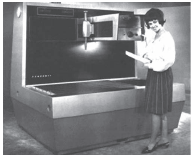
Fig. 2. One of the first examples of a coordinate measuring machine [6] Rys. 2. Jeden z pierwszych egzemplarzy współrzędnościowej maszyny pomiarowej [6]
