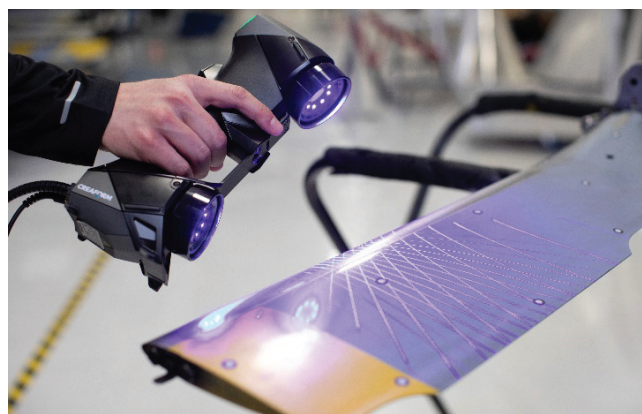
Fig. 6. Creaform 3D HandySCAN handheld laser scanner using blue light [16] Rys. 6. Ręczny skaner laserowy firmy Creaform 3D HandySCAN wykorzystujący światło niebieskie [16]
