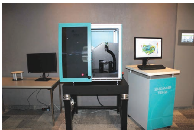
Fig. 5. Coordinate measuring scanner in the automatic station [15] Rys. 5. Współrzędnościowy skaner pomiarowy w automatycznym stanowisku [15]
