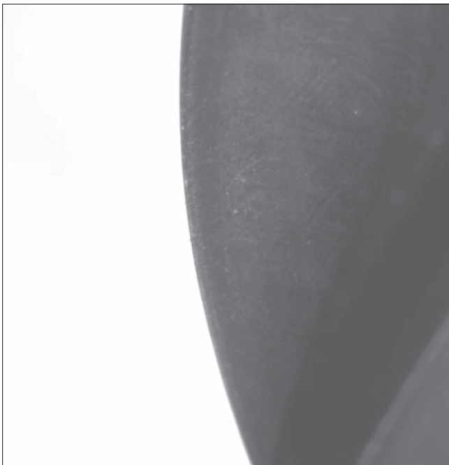
Fig. 9. Rake surface after machining time t_s = 38 min 1 s (variant 3) Rys. 9. Powierzchnia natarcia po czasie obróbki t_s = 38 min 1 s (wariant 3)
