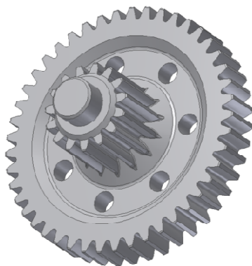
Rys. 3.3. Model bryłowy satelity 2 stopnia z dokładnym odwzorowaniem wrębów kół składowych [3]
