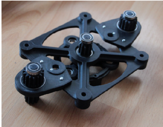
Rys. 5.1. Moduł napędowy podczas montażu [3]
