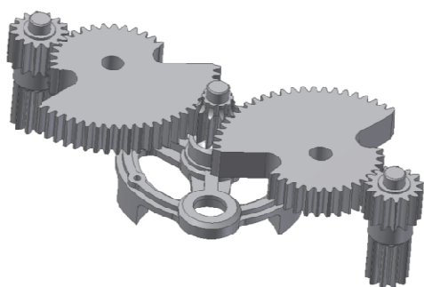
Rys. 3.5. Elementy układu napędu podnoszenia [3]
