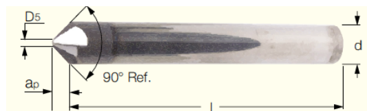
Rys. 1 Badane narzędzie frez ECF D-4/45-4C10 [12]
