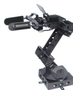
Rys. 3. Manipulator z możliwością obracania się, ruchów góra-dół, lewo-prawo
