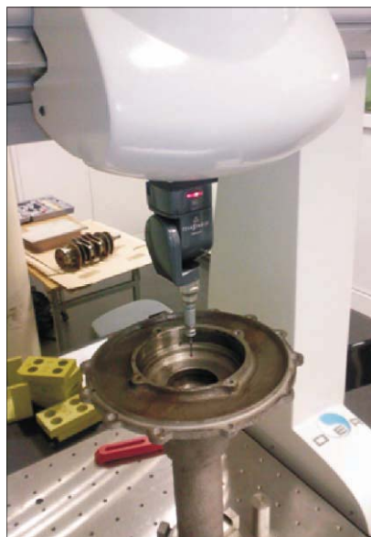
Rys. 3. Pomiar na maszynie współrzędnościowej elementów mostu napędowego
