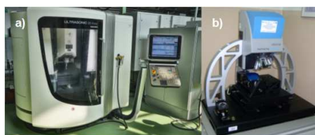
Rys. 2. Konfiguracja stanowisk badawczych: a) hybrydowa obrabiarka Ultrasonic 20 linear z układem wzbudzania drgań ultradźwiękowych narzędzia, b) mikroskop optyczny Infinite Focus Real 3D Alicona
