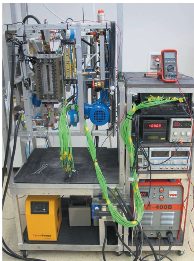
Rys. 4. Widok stanowiska badawczego od strony pomiaru temperatury powierzchni grzejnej
