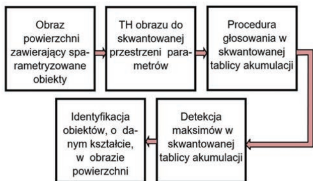
Rys. 1. Schemat blokowy pokazujący poszczególne etapy transformacji Hougha (TH) w zastosowaniu do identyfikacji kształtu sparametryzowanego obiektu
