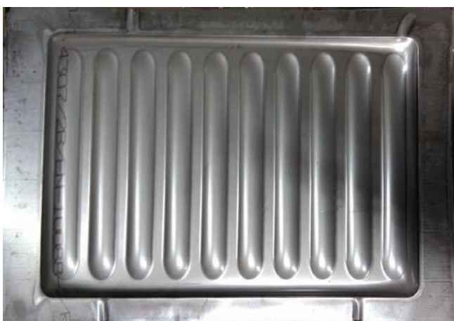
Rys. 7. Panel zbiornika wytworzony metodą formowania elastycznym stemplem
