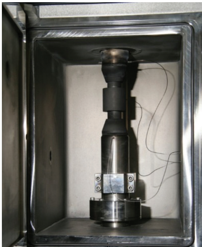
Rys. 1. System spiekania SPS – komora spiekania wraz z przygotowanym wsadem
