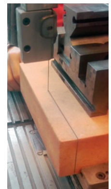
Fig. 6. The process of cutting ceramic blocks into whetstones using a fixed abrasive diamond wire Rys. 6. Proces przecinania bloczków ceramicznych na osetki za pomocą struny zbrojonej trwale
