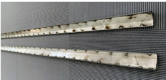
Fig. 4. The finished profile after forming process and spot welding which measurement 2000 mm Rys. 4. Gotowy profil po procesie formowania i spawania punktowego o długości 2000 mm
