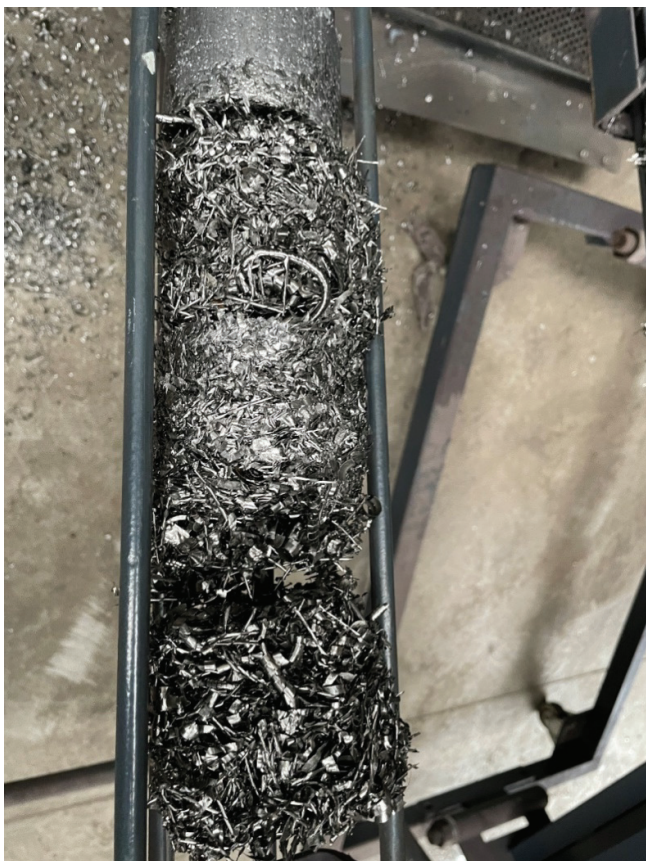
Fig. 1. Technical tests of chip consolidation Rys. 1. Próby techniczne konsolidacji wiórów
