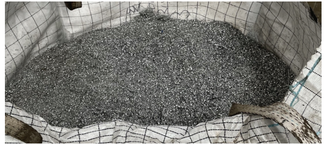
Fig. 3. Chips preparation for mechanical consolidation Rys. 3. Wióry przygotowanie do konsolidacji mechanicznej
