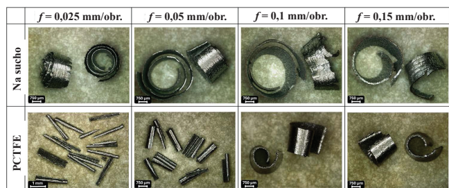
Rys. 2. Porównanie kształtu i morfologii wiórów przy skrawaniu na sucho i z cieczą PCTFE
