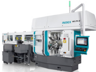
Technologia wielowrzecionowa INDEX do wysokowydajnych obróbek oraz szybkich przebrożeń – INDEX MS24-6
